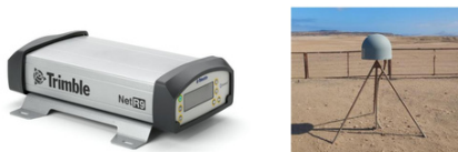
Fig. 3. Receptor Trimble NetR9 y antena GNSS con radome instalada en sedimento
